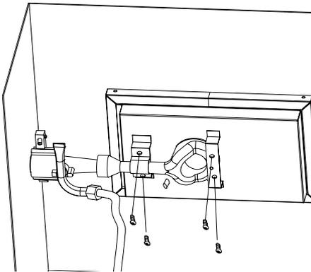
Step 12: Align & start knob bezel & valve Screws ( **DO NOT TIGHTEN**)
